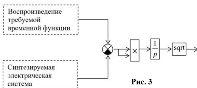
моделей предусмотрено наличие начального напряжения на конденсаторе C1, что обеспечивается с помощью блока GUI. Ток в выходном резисторе измеряется с помощью виртуального амперметра и является выходной величиной второй модели. Из выходного сигнала первой модели вычитается выходной сигнал второй модели. Разность сигналов возводится в квадрат, чтобы избежать взаимной компенсации положительных и отрицательных зна-
