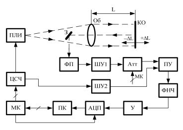
ем этапе с помощью АЦП производятся выборки исследуемого сигнала и передача их значений в ПК для оценки частотного спектра вибраций контролируемого объекта.
