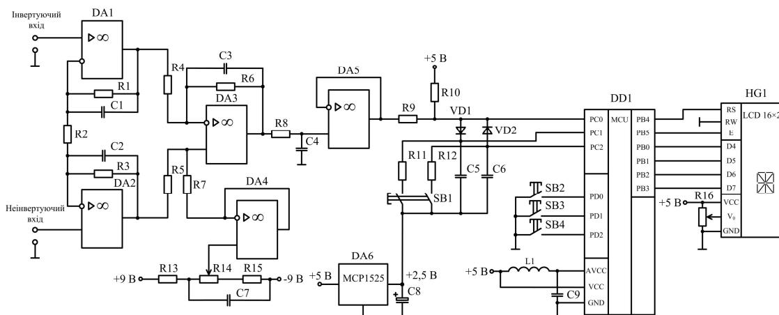
Коефіцієнт підсилення регулюється за допомогою резистора R2, при цьому коефіцієнт передачі синфазного сигналу при правильному виборі величини R7 практично дорівнює нулю. Завдяки цим позитивним властивостям схема на трьох ОП може бути базовою при побудові пристрій для посилення і реєстрації БЕП.
