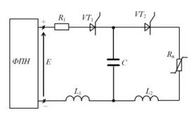
Принято допущение, что электрическое сопротивление нагрузки  $R_{\rm H}$  в разрядном контуре ФРИ неизменно в течение длительности каждого разряда конденсатора C, но в паузе между разрядами оно может изменяться, и его величина может характеризоваться непрерывной равномерно распределенной случайной величиной, изменяемой от  $r_{min}$  до  $r_{max}$ . При этом функция плотности вероятности  $R_{\rm H}$  равна
