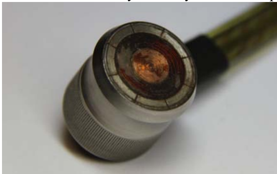
Рис. 1. Зображення в подробицях ЕМАП ультразвукового портативного товщиноміра з джерелом імпульсного намагнічування [14 фіг.6], наведеного в огляді дисертації [15, рис. 1.9]
