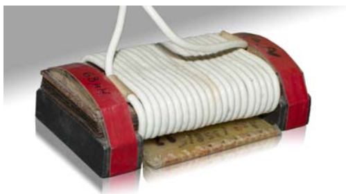
Рис. 3. Макет ЕМАП для збудження і прийому хвиль Релея, Лемба та хвиль нормального типу [17]
