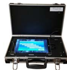
Рис. 1 – Формат параметричного аналізу ВКФ течешукача К-10.5М2 (а), радіоблок з датчиком на трубопроводі під час вимірювань (б), вібродатчики (в), виносні радіоблоки (г), блок оператора течешукача (д)
