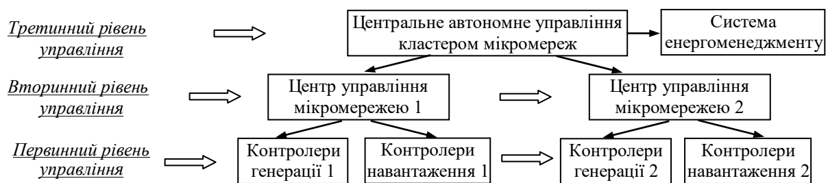
Рис. 6. Варіант системи трирівневого управління двох об'єднаних мікромереж
