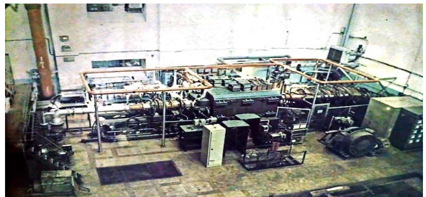
Фото 4. Експериментальна МГД-установка К-1 електричною потужністю 200 кВт
